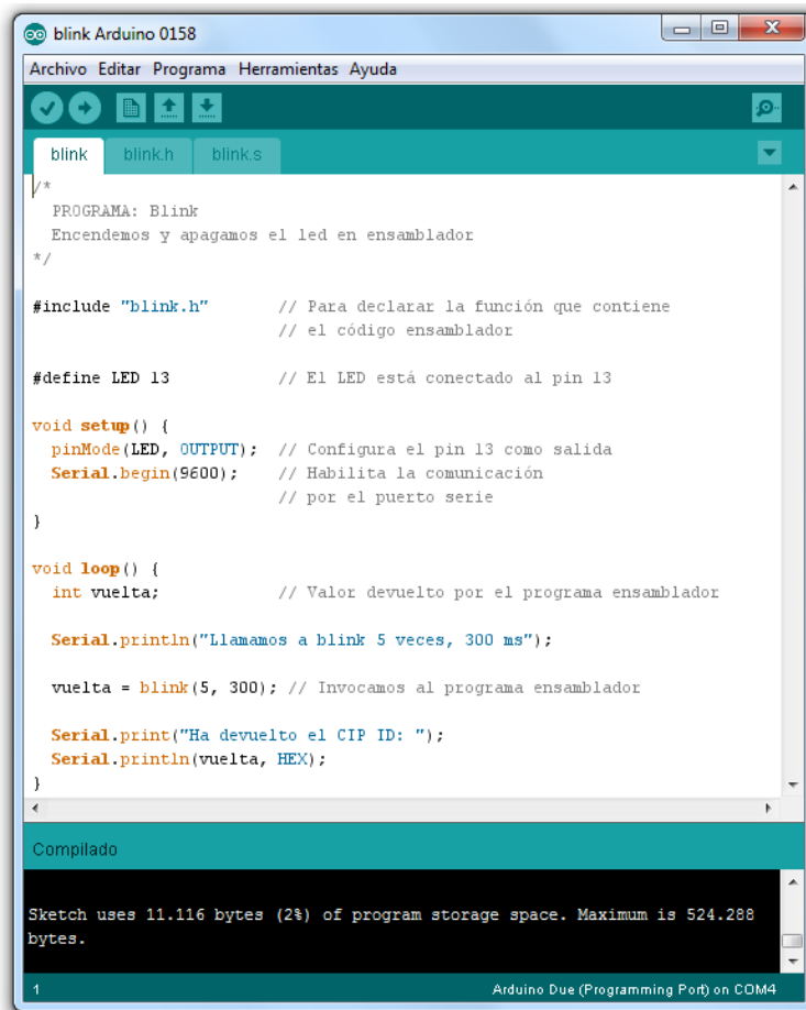
Figura 9.15: Resultado de la compilación del programa «blink»
